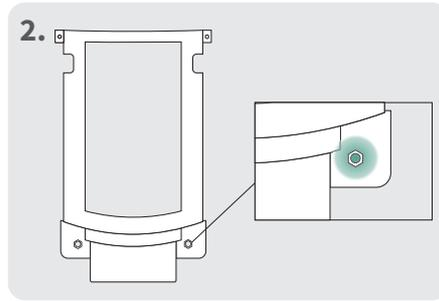
2. Setzen Sie die großen 6 Kant-Muttern in die Vorrichtung am schmalen Teil des Vandalismusschutzes.
