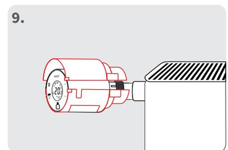
9. Nehmen Sie das Teil ohne Aussparung und stülpen Sie es von oben über den Avalon+ oder Avalon Combo+ Stellantrieb, so dass die Schraubenverbindungen übereinanderliegen.
