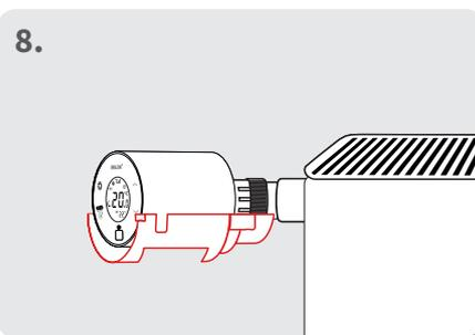
8. Stülpen Sie die Unterseite des Vandalismusschutzes mit der Aussparung für das Batteriefach von unten über den Avalon+ oder Avalon Combo+ Stellantrieb. Beachten sie, dass die Aussparung den Batteriedeckel freihält.
