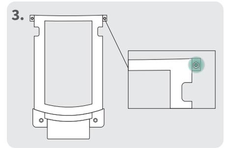
3. Setzen Sie die kleinen 6 Kant-Muttern in die Vorrichtung am breiten Teil des Vandalismusschutzes.
