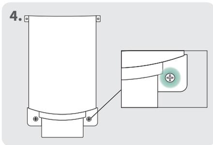
4. Drehen Sie die großen Schrauben in die Vorbohrung am schmalen Teil des Vandalismusschutzes.
