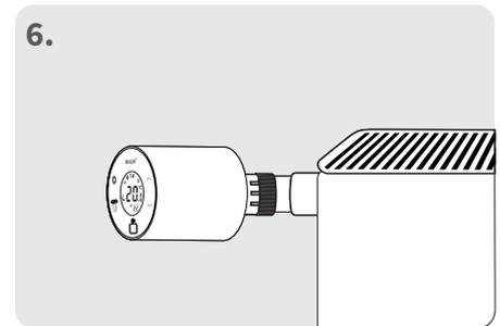
6. Stellen Sie sicher, dass der Avalon+ oder Avalon Combo+ Stellantrieb wie in der Anleitung beschrieben am Heizkörper montiert ist.
