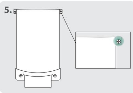
5. Drehen Sie die kleinen Schrauben in die Vorbohrung am breiten Teil des Vandalismusschutzes.
