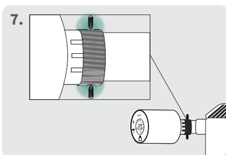
7. Drehen Sie die kleinen Gewindestifte in die zwei Löcher der Überwurfmutter am Thermostat um diesen fest zu arretieren.
